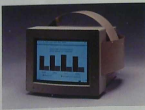
Рис. 1. Устройство ELF ProTech позволяет уменьшить интенсивность низкочастотного магнитного поля от отклоняющих катушек кинескопа.
